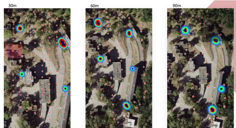
Aufnahmen der Wärmebildkamera der Drohne. Quelle: KomRe AG
